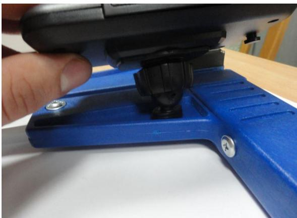
Подготовленный держатель положить на круглый элемент на круглой вилке. Далее поставить в нужную позицию и закрутить гайку по часовой стрелке, чтобы у stabilizeзировать держатель.
