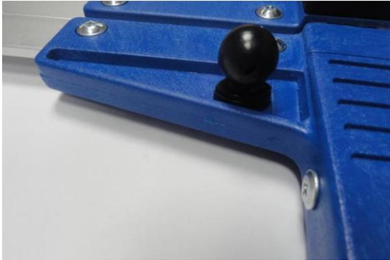
Элемент монтажа держателя для смартфона закреплен на неподвижной ножке мерной вилки при помощи винта.
