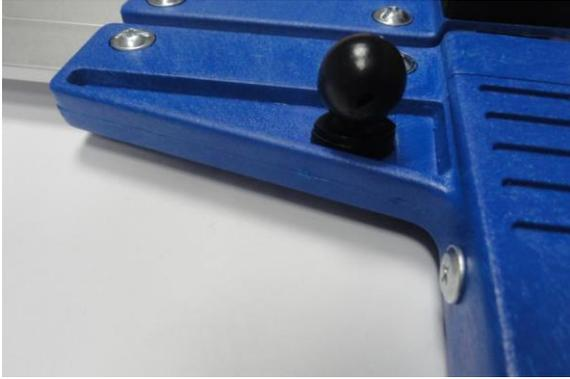
Elemento destinado a sujetar el soporte de smartphone está sujeto con un tornillo en el brazo fijo de la forcípula.
