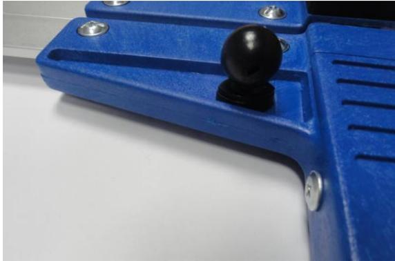
L`élément servant à joindre la poignée avec le smartphone est vissé sur une bride du diamètreur à l`aide d`une vis.
