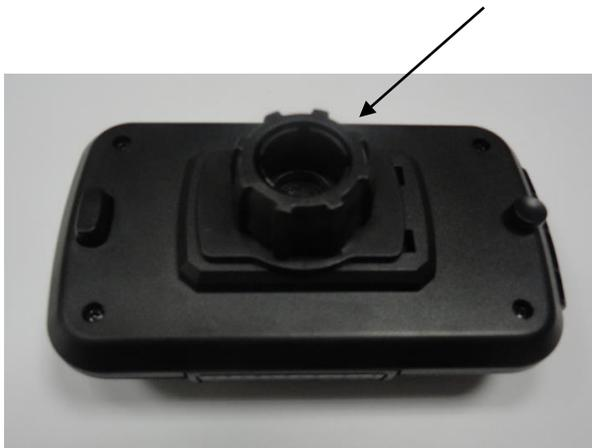
Il faut mettre la poignée de manière présentée sur la figure, puis par un mouvement vers la gauche il faut dévisser presque complètement l`écrou en plastique.
