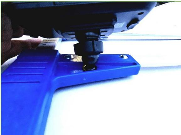
Setzen Sie den vorbereiteten Halter auf das kugelförmige Element der Messkluppe. Dann in die gewünschte Position bringen und mit einer Bewegung im Uhrzeigersinn die Mutter anziehen, um den Halter zu stabilisieren.
