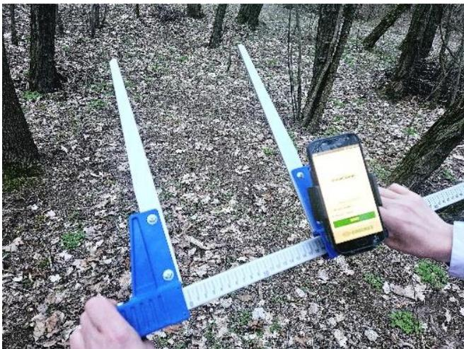
Vor der Messung muss das Smartphone in der Halterung an der Messkluppe befestigt werden.
