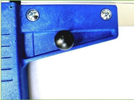
Das Bauteil zur Befestigung des Smartphone-Halters wird mit einer Schraube auf die bewegliche Backe der Messkluppe geschraubt.
